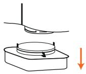
3- Positionner les crans du nouveau filtre dans les encoches de l'emplacement et pousser à fond. Tourner le filtre dans le sens inverse des aiguilles d'une montre, jusqu'à la butée.
